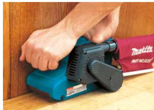
Gewebeschleifbänder 76 x 533 mm
